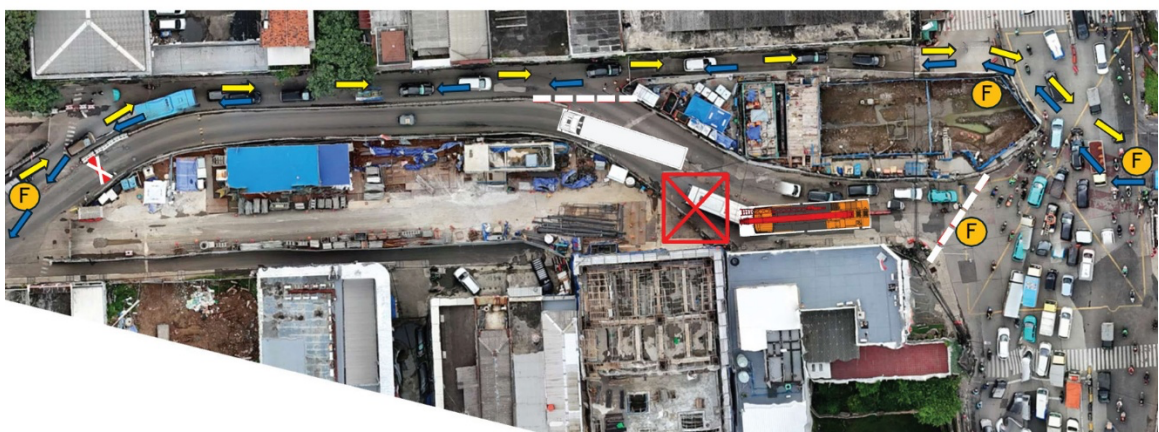
Gambar 1. Rekayasa lalu lintas Jl. Pintu Besar Selatan saat dilakukan pekerjaan, mulai jam 22.00 – 04.00 WIB.
